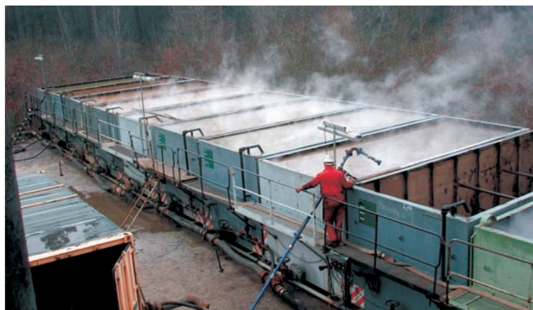
Fördertest nach hydraulischen Stimulationsexperimenten
