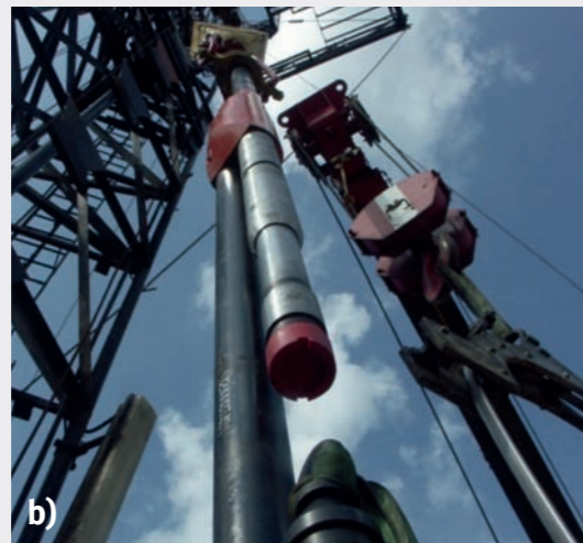
v.l.n.r.: a) Rohreinbau zur Sicherung der Bohrung; b) Einbau eines so genannten Y-Tools, das Bohrlochmessungen während der Thermalwasserproduktion ermöglicht; c) Thermophysikalische Fluidmessungen im Labor
